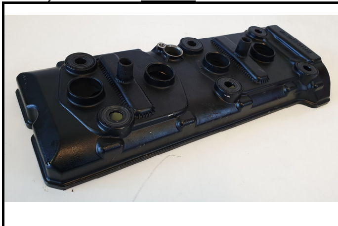
C1-3) Couvre culasse - déposé Cylinderhead cover - dismounted
