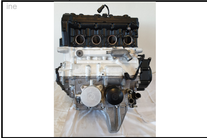
C1-3) Couvre culasse - déposé Cylinderhead cover - dismounted
