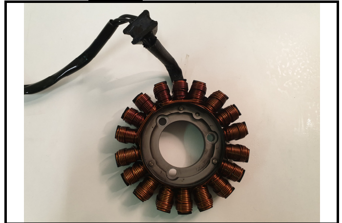
C15-2) Stator - déposé Stator - dismounted
