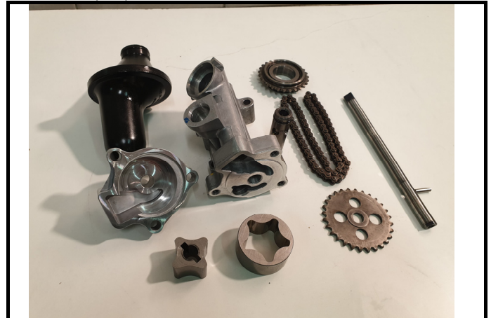
C14-3b) Pompe à huile - déposée Oil pump - dismounted
