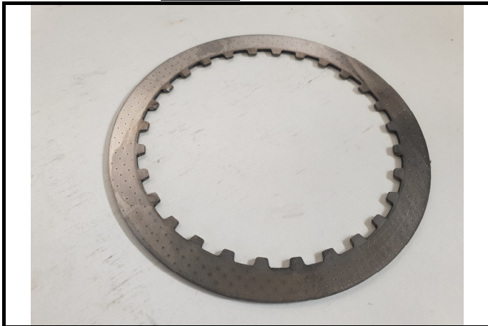
C17-3) Disque mené - déposé Driven disk - dismounted
