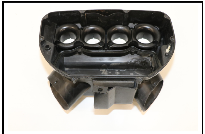
C11-4) Boitier papillon - déposé Throttle unit - dismounted
