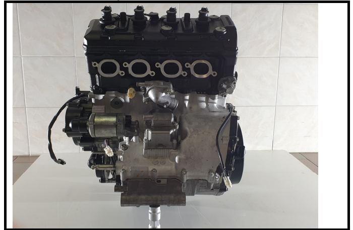
C1-4) Couvre culasse - déposé Cylinderhead cover - dismounted
