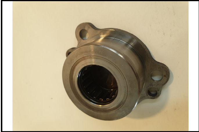
F8-3) Roulement droit de l'arbre secondaire Right mainshaft bearing
