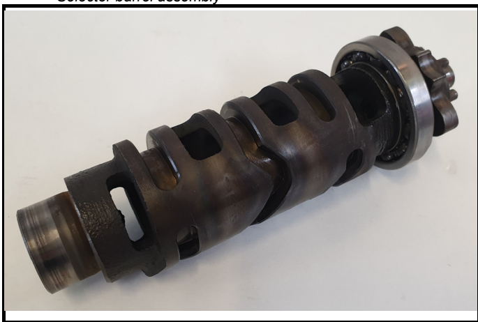
F9-4) Assemblage du barillet Selector barrel assembly
