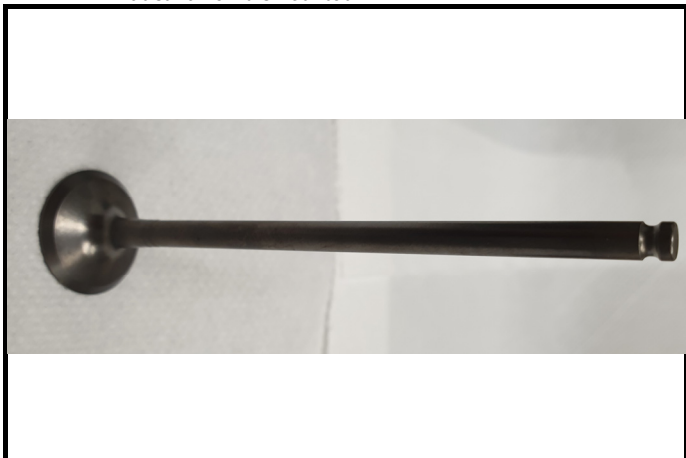
C12-1) Soupape échappement - déposée Exhaust valve - dismantled
