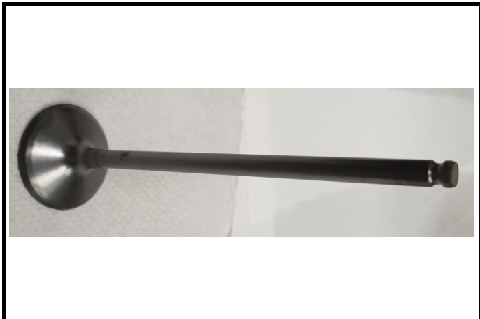
C11-5) Soupape admission - déposée Intake valve - dismantled
