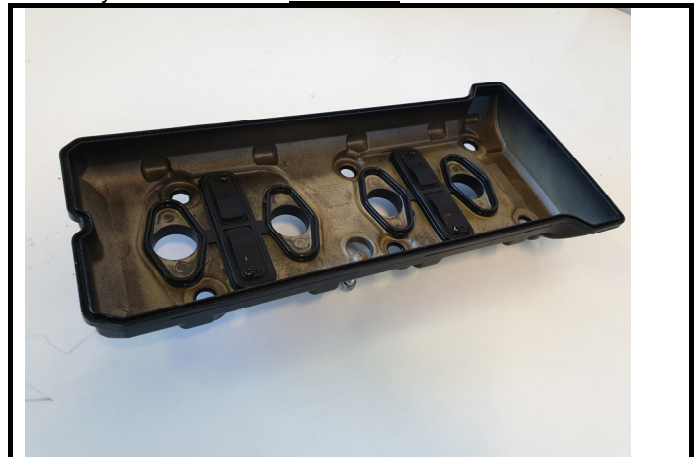
C1-4) Couvre culasse - déposé Cylinderhead cover - dismounted
