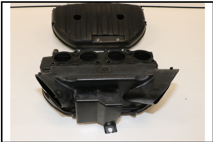
C11-3) Boitier papillon - déposé Throttle unit - dismounted
