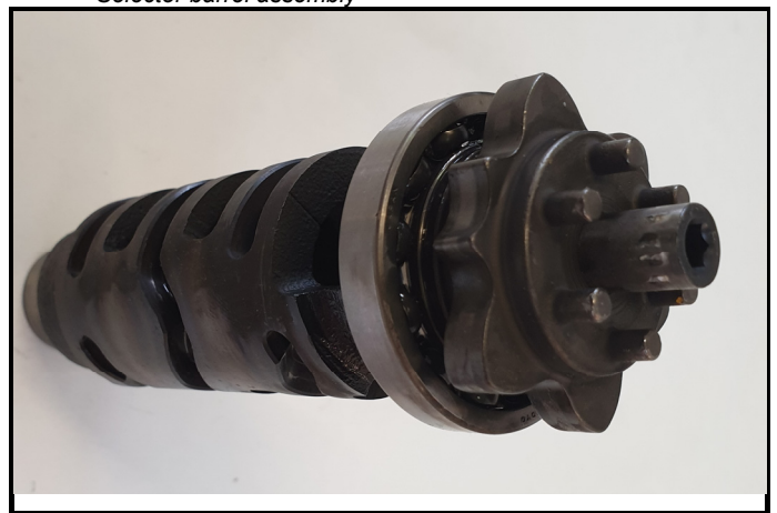
F9-5) Assemblage du barillet Selector barrel assembly
