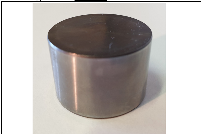
C10-6) Poussoir Admission - démonté Tappet Intake - dismounted
